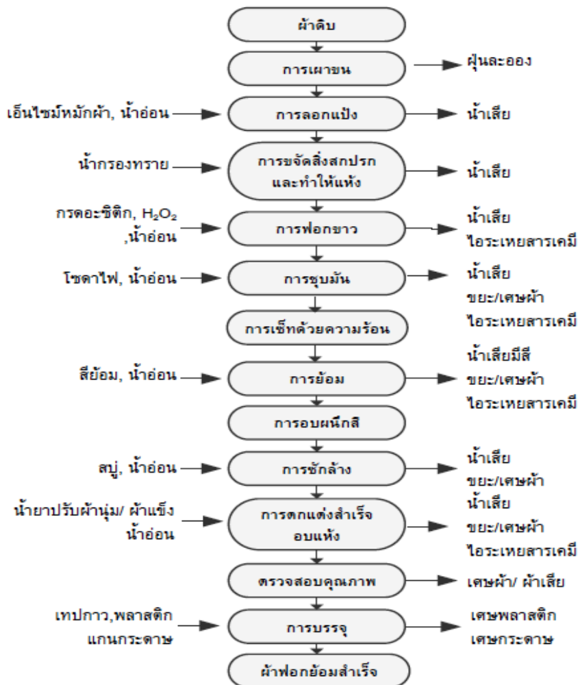
รูปที่ 4-3 ตัวอย่างวัตถุดิบและของเสียที่เกิดขึ้นในกระบวนการฟอกย้อมผ้าผืน 82
