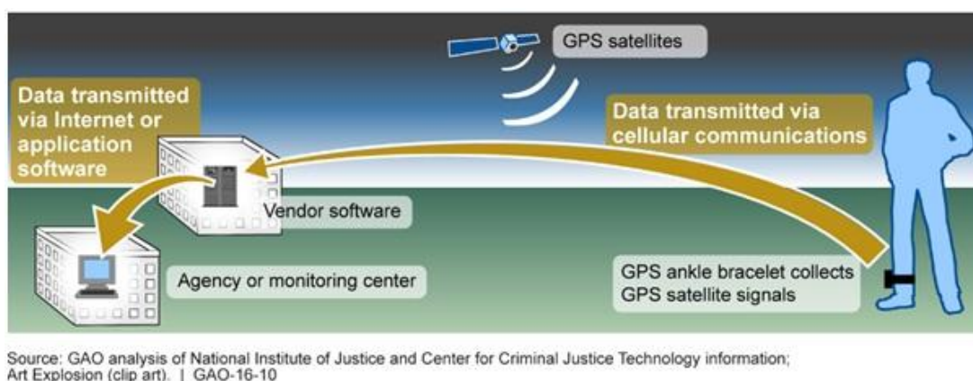
ภาพที่ 2.1 หลักการทำงานของระบบอุปกรณ์อิเล็กทรอนิกส์ติดตามตัว
