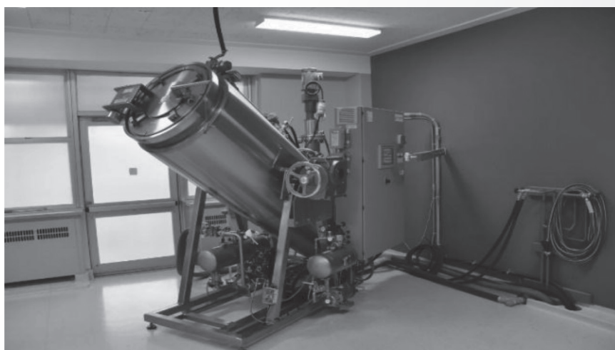
รูปภาพที่ 1 แสดงเครื่อง Bio Cremation ที่ใช้ในกระบวนการการฉาปนกิจศพด้วยน้ำ
